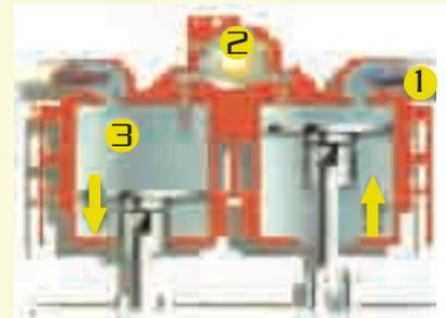
El coche debe su autonomía a los depósitos de fibra que almacenan 90m<sup>3</sup> de aire comprimido a 300 bares. La expansión del aire comprimido introducido en un recinto cerrado (el cilindro) impulsa los pistones, consiguiendo así el movimiento.
