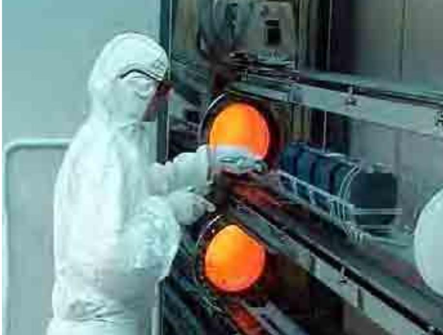
Con la tecnología Saturno, BP Solar fabrica en Madrid más del 5% de la producción mundial de células fotovoltaicas. En las imágenes, dos momentos del proceso de preparación de las obleas para transformarlas en material semiconductor y facilitar la circulación de cargas eléctricas.
