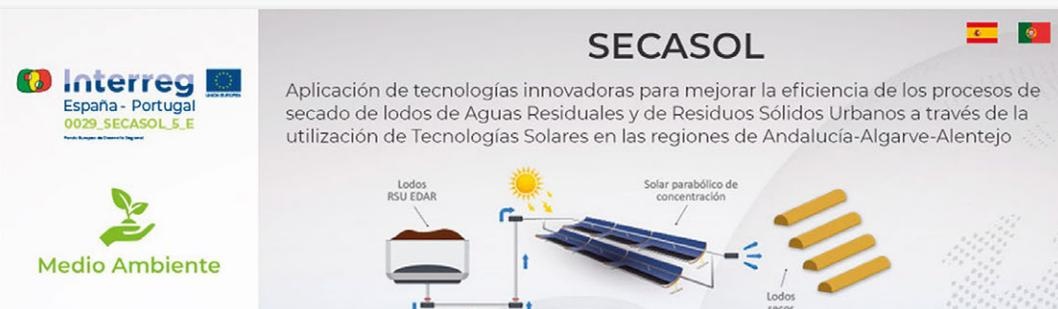
El proyecto Secasol, que se está desarrollando en Andalucía y sur de Portugal, ha recurrido a la energía solar de concentración, en concreto a los espejos Fresnel, para secar los lodos procedentes del tratamiento de las aguas residuales y del lixiviado de los residuos domésticos. De esta forma espera reducir hasta la mitad el uso de combustibles fósiles en este proceso y minimizar la carga tóxica de los lodos, hasta el punto de que podrían ser reutilizados para regenerar suelos degradados.
