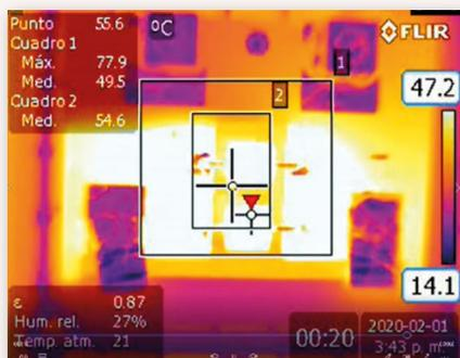
a) Diodos de paso defectuosos conduciendo todo el tiempo
